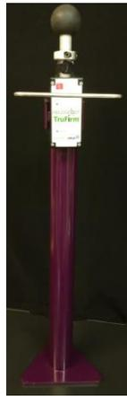
コンパクションは土壌の固さを示す数値である。試験地に対し、Trufirm(下中央図)を用いて27回(9回/m<sup>2</sup>)測定しコンパクション値として集計した。なお、本測定機は、円筒内の金属棒を一定の高さから落とし、そのへこみの深さを測定することでコンパクションとしており、数値が低いほど固い。
