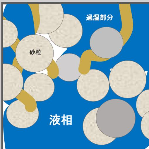
土壤の間隙が水で満たされている
