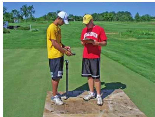
▲ガイド用穴のある木製ボードを使用して試験区の土壌水分を格子状パターンで測定しているところ。
